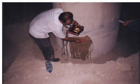
شکل ۵ - تست HALF CELL به منظور تشخیص میزان خوردگی
