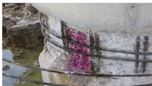
شکل ۶- جایگزینی بتن با ملات الیافی FRC دارای MCI شکل ۷- بتن قلبیایی سالم در تست فنل فتالین
